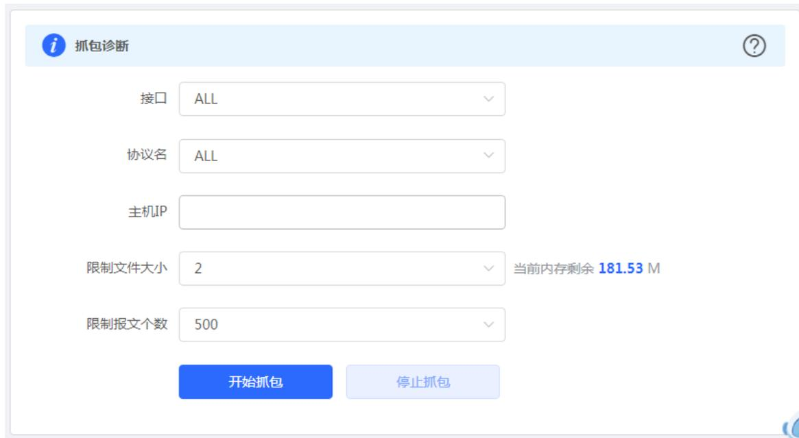
抓包过程中可随时停止，生成下载链接。点击链接可保存pcap格式的抓包结果到本地，用Wireshark等分析软件进行查看与分析。
