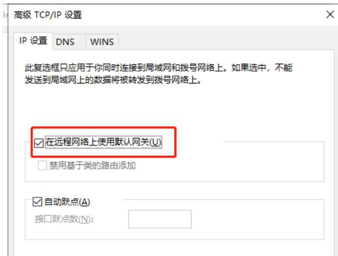
f 上述步骤已完成PC的PPTP客户端设置，接下来可以在PC上发起VPN连接。点击任务栏的网络图标
