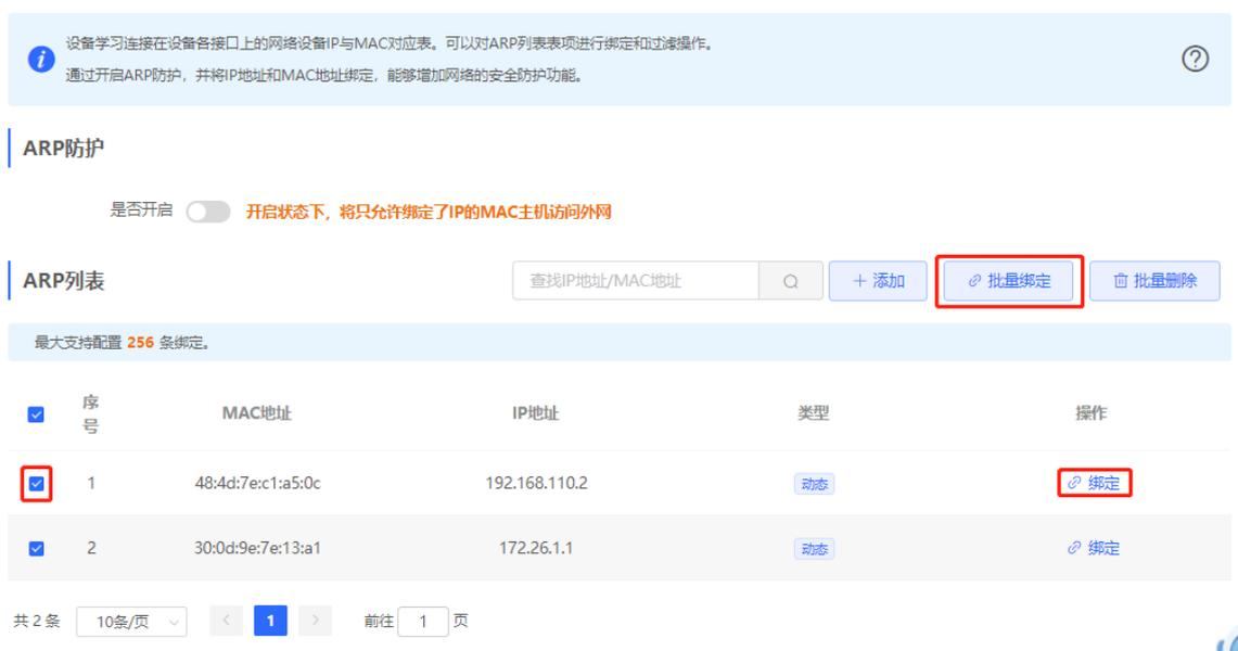
(2) 点击<添加>按钮，输入绑定的IP地址和MAC地址。输入框将弹出ARP列表中已存在的地址映射信息，点击可自动填入。点击<确定>完成绑定。
