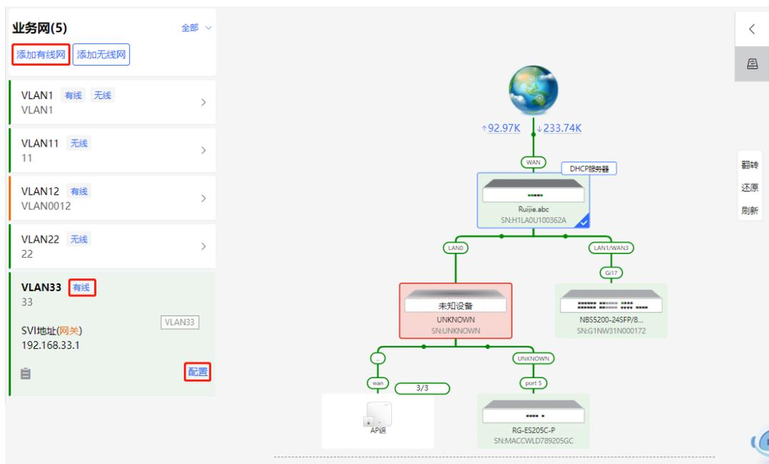
(2) 设置用于有线接入的VLAN、该VLAN下接入终端的地址池服务器以及是否创建新的DHCP地址池。默认网关设备作为地址池服务器为接入终端分配地址，当组网中存在接入交换机，可选择交换机作为地址池服务器。完成业务参数设置后，点击<下一步>。
