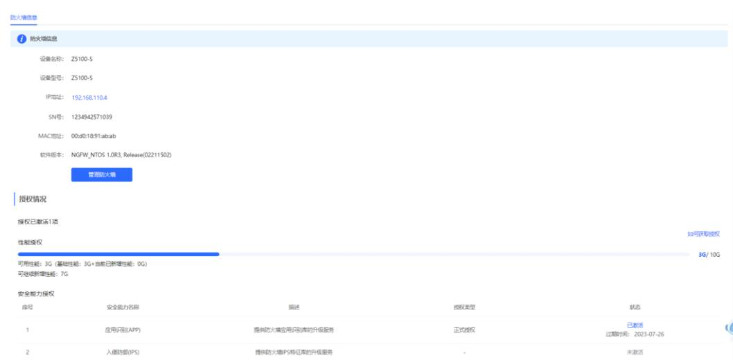
点击<管理防火墙>可跳转到防火墙设备的Web管理界面，配置防火墙安全策略、授权激活等操作。具体操作步骤，请参见对应防火墙设备的Web管理手册。
