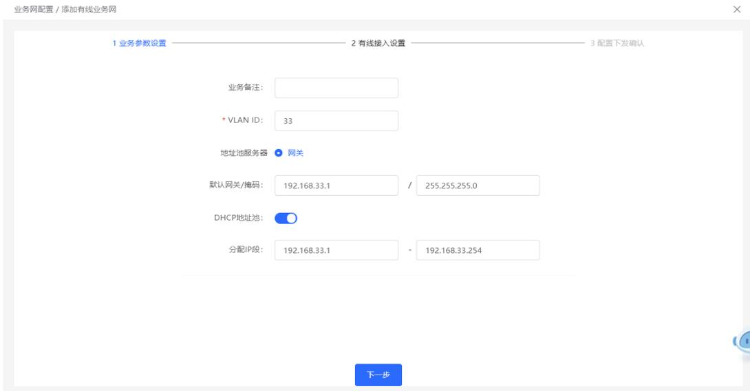
(3) 在拓扑中选择需要配置的交换机，并选择VLAN所包含的交换机端口，点击<下一步>。
