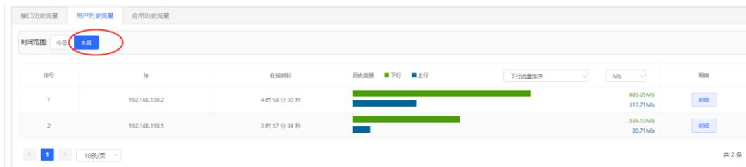
有多个用户时，系统默认按照下行流量降序排序显示，可查看设置时间范围内每个用户的在线时长、上下行流量等数据。排序方式可切换为上行流量排序或下行流量排序。可根据业务需要，设置流量单位、当前页面展示的条数，分页显示等功能。
