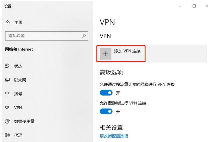
b 点击“添加VPN连接”，选择VPN提供商为Windows，VPN类型为“点对点隧道协议(PPTP)”填写连接名称和服务器的地址或者域名，点击保存即可。
